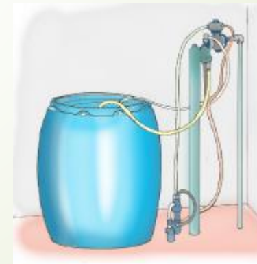
Sistema eléctrico o por gravedad de cloro por goteo. (Código T1)
